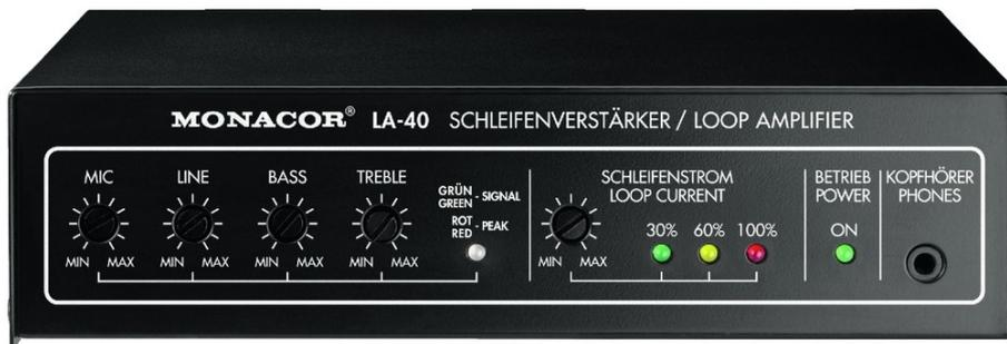
L'amplificateur à boucles LA-40 transmet les signaux audio de téléviseurs, système audio et / ou microphones dans la boucle d'induction se trouvant dans le plafond, mur ou sol. Au sein de la boucle se crée un champ magnétique, capté via la bobine téléphone de l'appareil auditif ou via le récepteur et est converti en signal audio.
